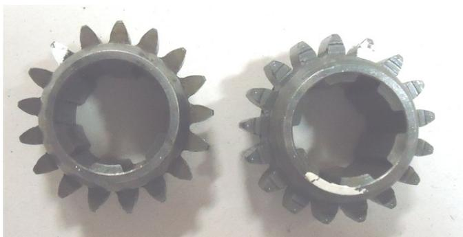
Figura 1: Engrenagem genuína à esquerda e alternativa à direita.
